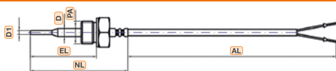
Kabelfühler mit Verschraubung (fest) Außengewinde, Schutzhülse verjüngt
